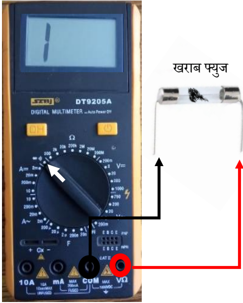
चित्र २५: जलेको फ्युजको परीक्षण गर्दा मल्टिमिटरले खुल्ला सर्किट सङ्केत गरेको अवस्था
