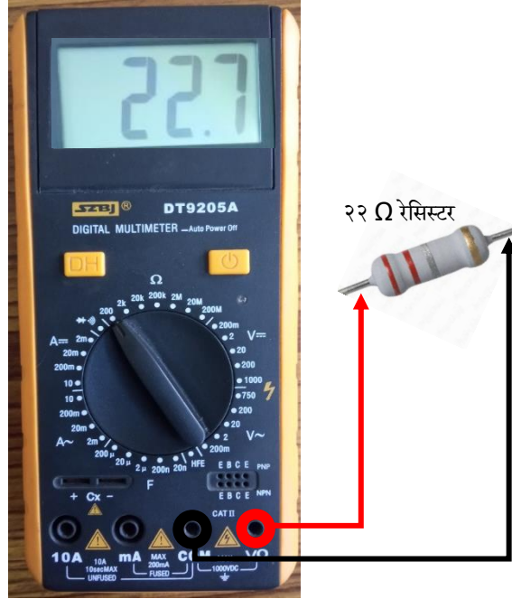
चित्र ३६: मल्टिमिटरद्वारा रेसिस्टर परीक्षण गर्ने तरिका
