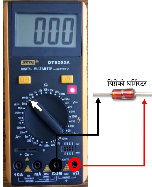
चित्र ३०: बिग्रेको थर्मिस्टर परीक्षण गर्दा निरन्तरता देखिएको
