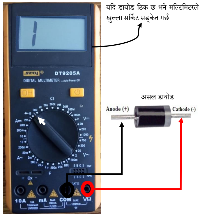
चित्र ३९ : असल डायोडले खुल्ला सर्किट सङ्केत गरेको अवस्था
