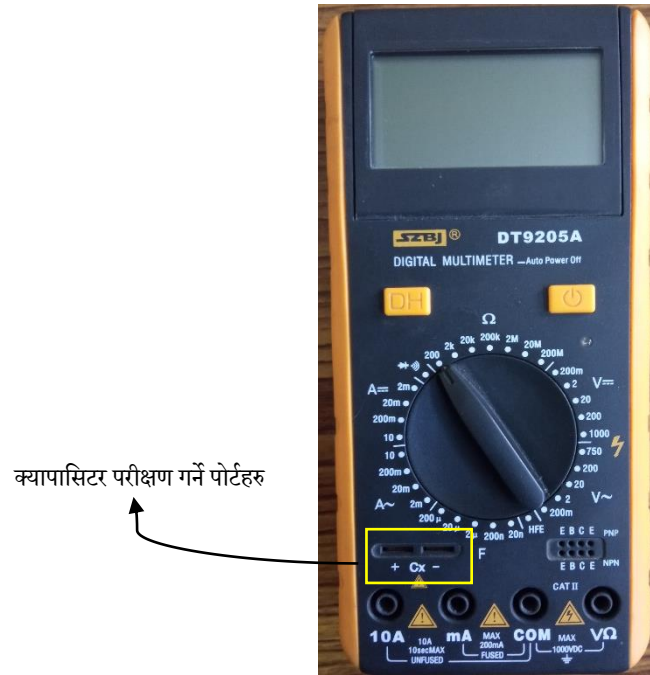
चित्र नं ४३: क्यापासिटर परीक्षण गर्न मिल्ने मल्टिमिटर
