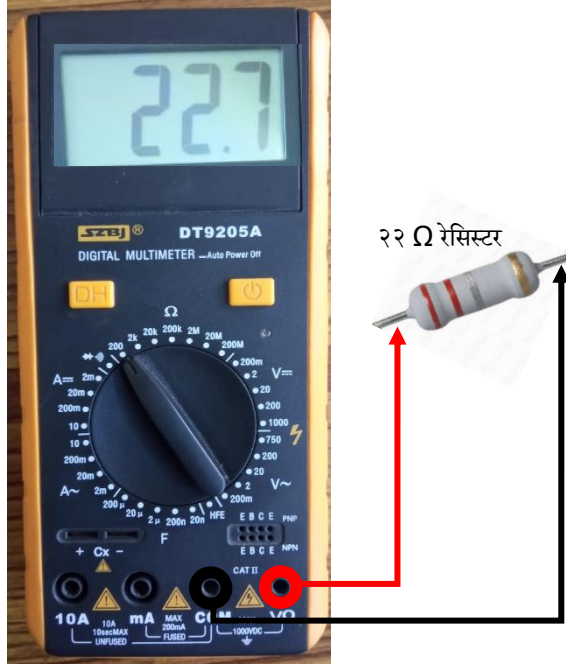
चित्र ४६: मल्टिमिटरद्वारा रेसिस्टर परीक्षण गर्ने तरिका
