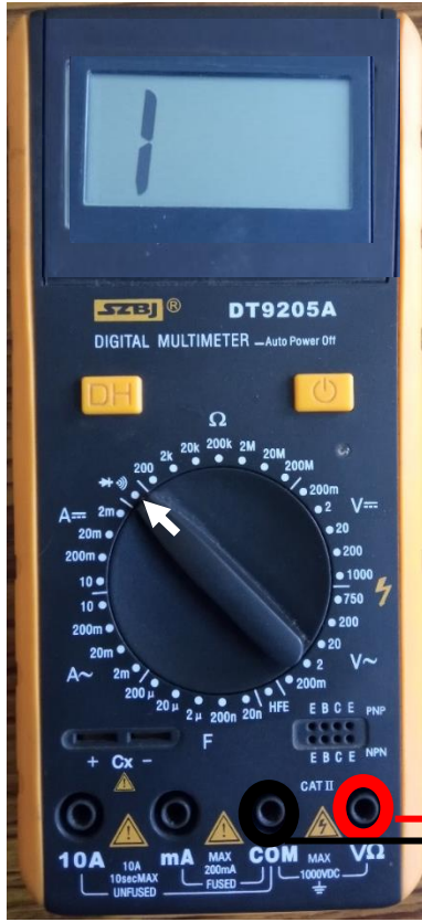
चित्र नं ३१: असल IGBT ले B र C पिन बीच खुल्ला सर्किट सङ्केत गरेको अवस्था
