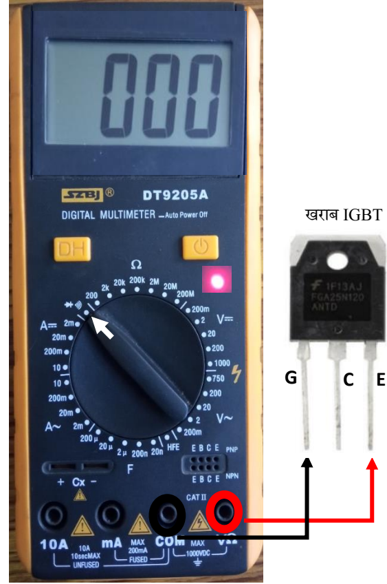
चित्र नं ३२: खराब IGBT ले B र E पिन बीच सर्ट सर्किट सङ्केत गरेको अवस्था
