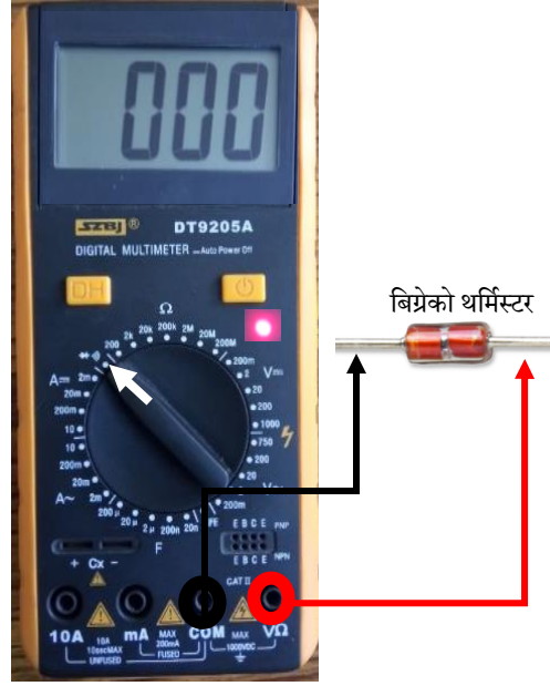
चित्र ४७: बिग्रेको थर्मिस्टर परीक्षण गर्दा निरन्तरता देखिएको
